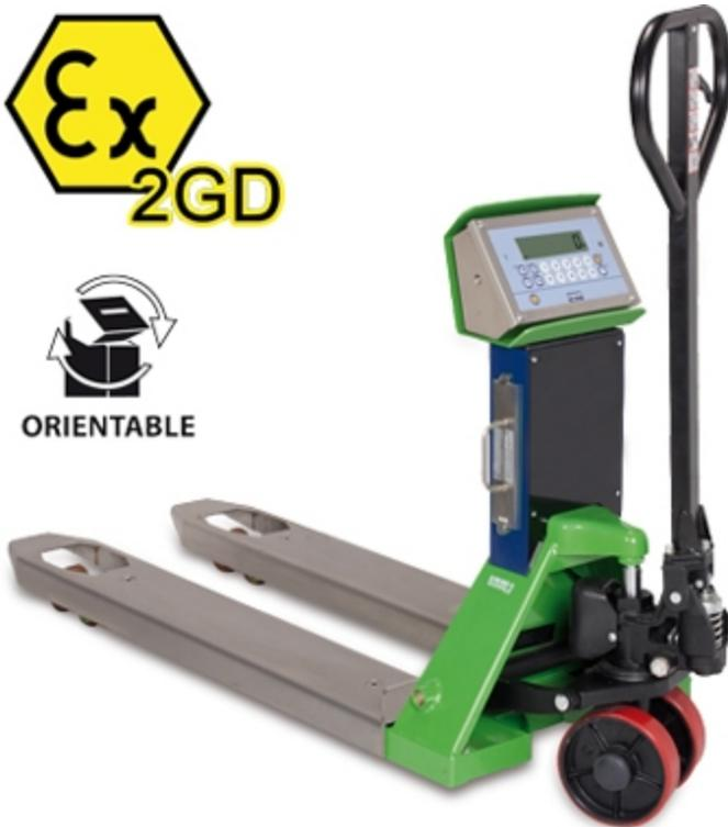
Gabelhubwagen mit Waagenfunktion, geeignet für den Einsatz in explosionsgefährdeten Bereichen (ZONEN 1 und 21 & 2 und 22), ATEX-Kennzeichnung Ex II 2GD IIB T4 T197°C X. Die Lastaufnahme über 4 ATEX-zertifizierte Wägezellen garantiert optimale Wägeregebnisse in allen Betriebsarten. Verfügbar auch in eichfähigen Versionen (CE-M).
